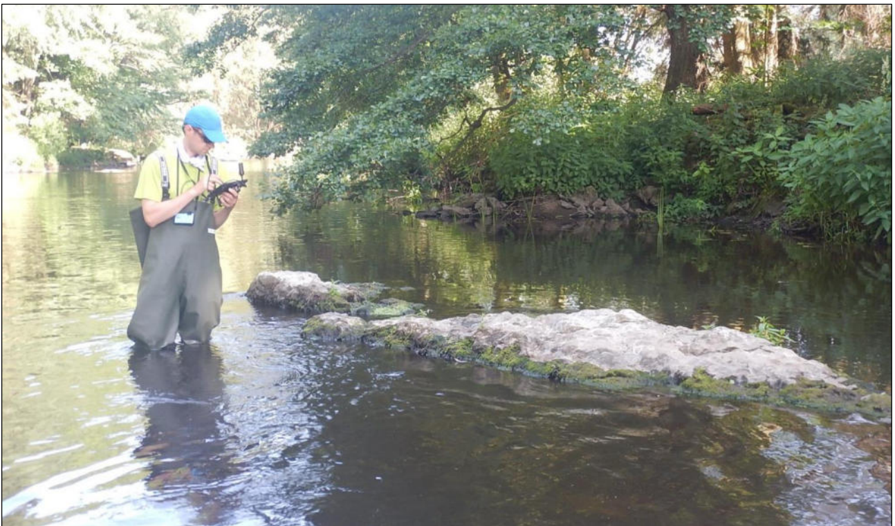
Abb. 78: Sächsische Saale bei F-km 28,08 – Aufnahme der Habitat- / Sonderstrukturen mittels hochauflösendem GNSS-Gerät ( G lobal N avigation S atellite S ystem)
